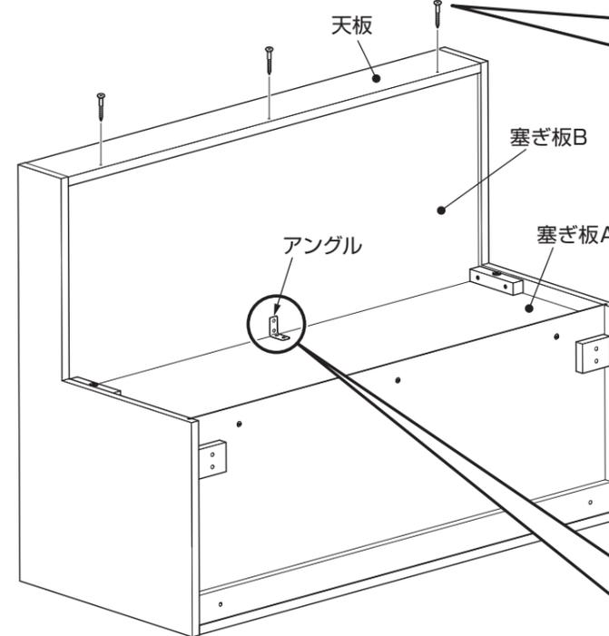
① 天板に抜き穴を開け、皿木ねじで天板から塞ぎ板Bの木口へ固定する。
