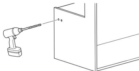
2 側板の外側から上記で開けた貫通穴にヒレ付鬼目ナットを打ち込む
