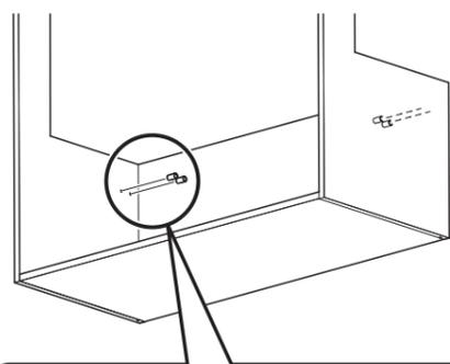
側板内側のφ6の下穴に鬼目ナットを付属の六角レンチを使用してねじ込む
