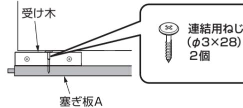
② トラストッピンねじで裏板から塞ぎ板Aを固定する
