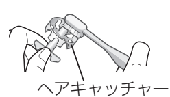
排水栓の裏側
