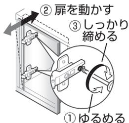
※固定ねじの場合は、調整後、固定ねじをしっかりと締める。
