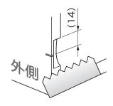
②切り欠き部の上側をマイナスドライバーで化粧板側 (外側)から突き破ってください。 ※内側から突くと化粧板が欠けます。
