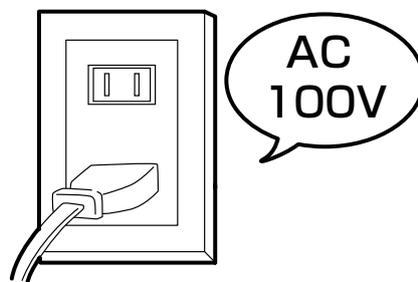
AC100V以外を使用すると過電流による火災の原因になります。
