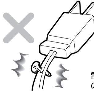
電気コードを傷つけると漏電および火災の原因になります。
