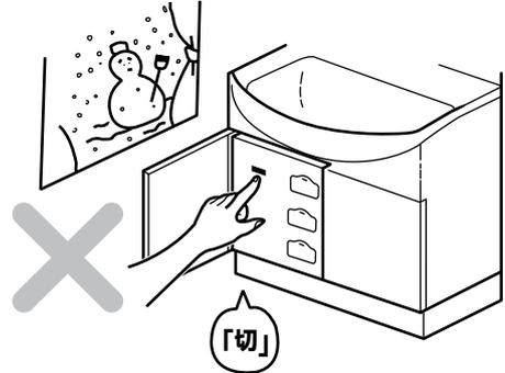
凍結破損し、水漏れする原因になります。
