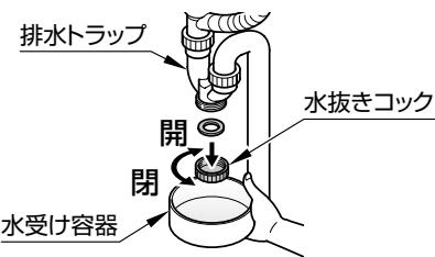
**2 水抜き後、水抜きコックを閉じる**
