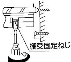
③パッキンが抜け落ちない様に注意してシールをはがした後棚板をセットし、壁取付座の方へ押し込んでから棚受固定ねじをしっかりと締めつけてください。
