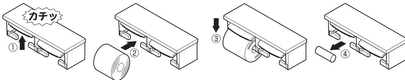
**YH651型** ■芯の内径13~15mm、直径120mm以下、幅114mm以下のペーパーを使用してください。
