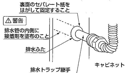
※ 排水管 (VP25エルボ又はソケット) の内側に接着剤を塗布し、排水トラップ継手に排水ふたを入れて、排水トラップ継手を差込んでください。
